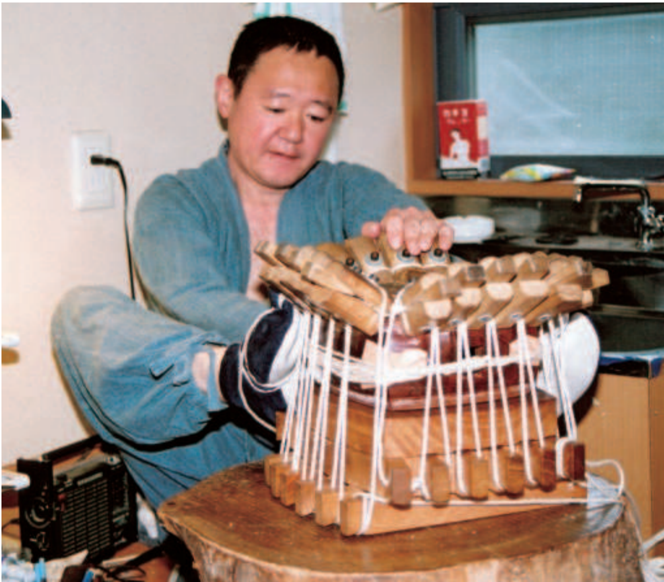
▲皮の周囲に大きな洗濯ばさみのような木柱(きせん)をかけ、もち糊を塗った胴に被せる。端を凹凸に切り出した張り台に乗せ、紐をかけながら引っ張る。繊細かつ力のいる大仕事だ
