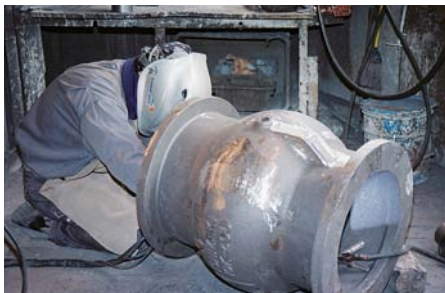
▲鋳仕上げの作業風景。湯道(ランナー)などのバリを切断。小さな気孔も見逃さずに溶接していきます
