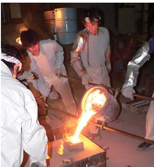
▲どろどろに溶けた灼熱の金属が鋳型の湯口に注ぎ込まれています。息を合わせ、神経を集中させる鋳込み作業は、匠の技が光る真剣勝負です！工場内に緊張感が張り詰めました
