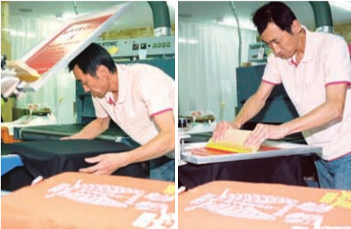
▲印刷台にシルクスクリーン(刷版)とTシャツをセットして、1枚ずつインクを刷り込みます
