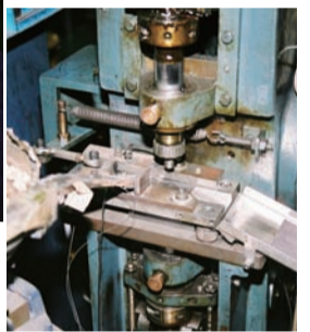
▲焼結が完了した製品は、ひび割れなどがないか厳しくチェックされた後、全自動サイジングプレス(写真右)にかけられ、仕様どおりの寸法に最終調整される
