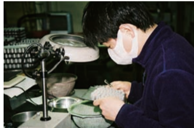
▲焼結が完了した製品は、ひび割れなどがないか厳しくチェックされた後、全自動サイジングプレス(写真右)にかけられ、仕様どおりの寸法に最終調整される
