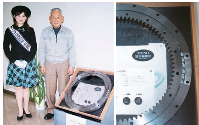
▲同社の玄関ホールに展示されている旋回輪軸受(内歯型)の製品例。内部構造が見えるように、外輪の一部をカットしてあるので、ボールと間座が交互に並ぶ様子がよく分かります
