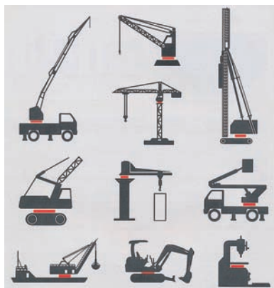
▲旋回輪軸受の主要3タイプ(上から、内歯型、外歯型、歯なし型)。さまざまな建設機械・産業機械の回転部分に使用されています
