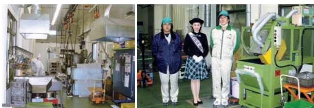
▲上尾第三工場の樹脂含浸処理ラインと自動タンブラー塗装ライン
