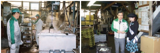
▲上尾第一工場の樹脂含浸処理の作業風景。加工される部品は、作業工程表を基にロットごとに仕分けしてトレーサビリティ(作業工程の履歴)を明確化。自動化による作業効率の向上とともに、品質マネジメント体制も周知徹底
